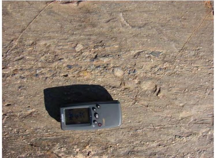
A utilização de GPS para localizar e medir a orientação de estruturas sedimentares e metamórficas
